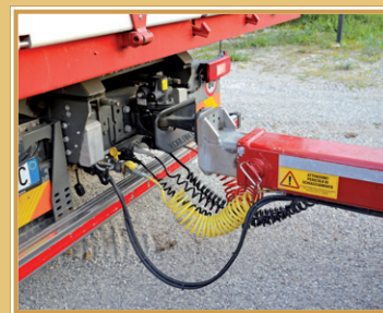
Particolare del timone registrabile in lunghezza e altezza Detail showing drawbar is adjustable in length and height Detail der längen- und höhenverstellbaren Deichsel
