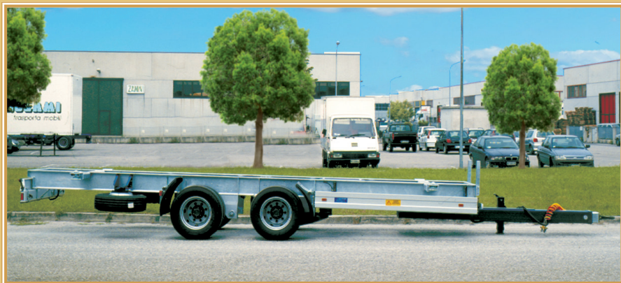
BP20W - Rimorchio ad assi centrali per carrozzerie scarrabili DIN - UIC DIN –UIC swap-body central-axle trailer Zentralachsanhänger für abnehmbare Aufbauten DIN - UIC
