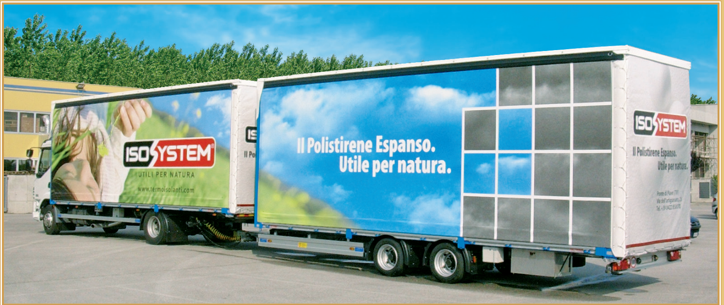
BP14W - Rimorchio furgonato gran volume con assi da 17.5" con primo asse sollevabile Large volume box trailer with 17.5" axles and axle lift for the 1st axle Anhänger mit Kofferaufbauten großvolumig Achsen zu 17.5" mit erster Achse anhebbar
