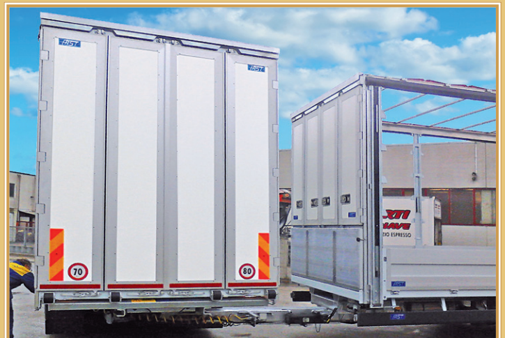
Schiena convoglio agganciato con particolare porte e ribalta integrata Trailer coupled with tractor showing detail of doors and built-in tilting tailgate Schleppzug eingekuppelt mit Detail Türen und integrierte Klappe
