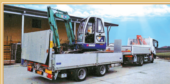
BP14W - Rimorchio con timone alto munito di rampe idrauliche per carico Trailer with high drawbar equipped with folding hydraulic ramps for loading Anhänger mit hoher Deichsel und hydraulischen Klapprampen zum Beladen
