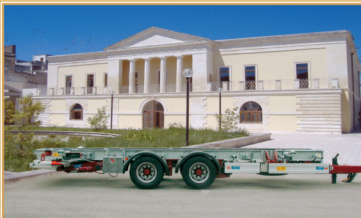
BP20WA - Rimorchio 2 assi scarrabile con sponda idraulica FAST Swap-body tandem-axle trailer with FAST hydraulic tailgate 2-Achsen-Anhänger mit hydraulischer FAST Klappe
