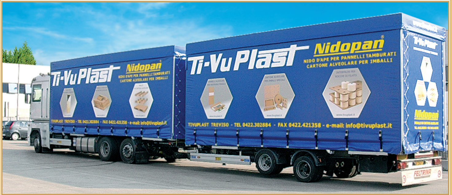
BP17W - Rimorchio furgonato gran volume con assi da 17.5" scarrabile con primo asse sollevabile Swap-body large-volume box trailer with 17.5" axles and axle lift for the 1st Anhänger mit Kofferaufbauten großvolumig Achsen zu 17.5" abnehmbar mit erster Achse anhebbar
