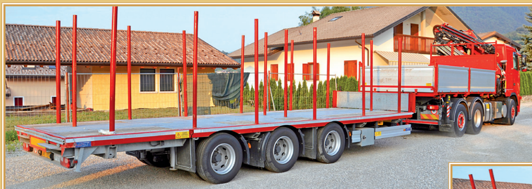
BP28WX - Biga 3 assi con timone alto, 1° asse sollevabile, 3° asse sterzante 3-axle truck trailer with high drawbar, axle lift for the 1st axle, steering Zentralachsanhänger mit 3 Achsen mit hoher Deichsel, 1. Achse anhebbar, 3. Achse lenkend
