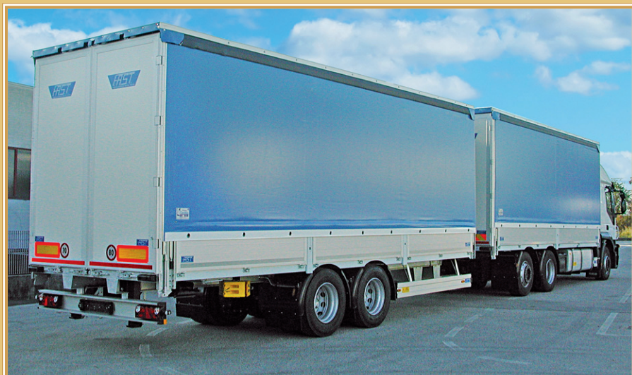
BP20WA - Convoglio motrice-biga con sistemi apertura telone e tetto Tractor and central-axle trailer with tarpaulin and roof opening systemS Schleppzug Zugmaschine-Zentralachsanhänger mit Systemen zum Öffnen von Plane und Dach
