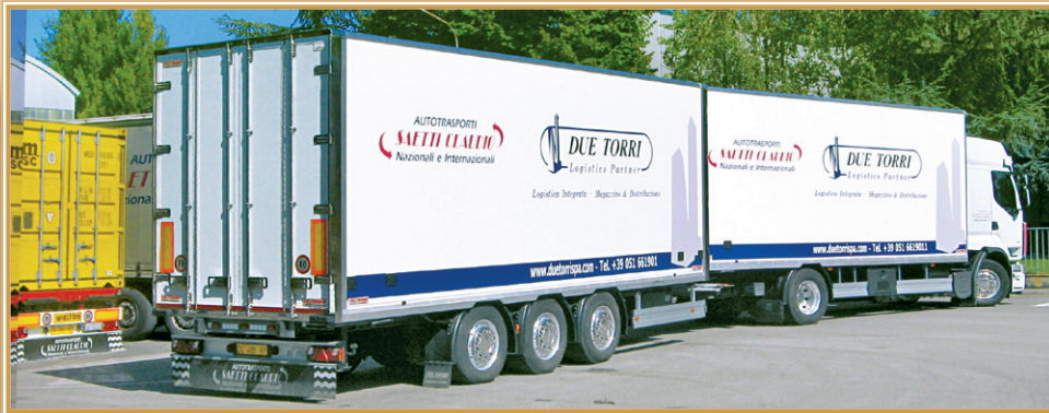
BP26WSA - Biga a 3 assi (il primo sollevabile e il terzo autosterzante) Chariot BP26WSA 3-axes (the first liftable and the third steering) Zentralachsanhänger mit 3 Achsen (die erste anhebbar und die dritte selbstlenkend)
