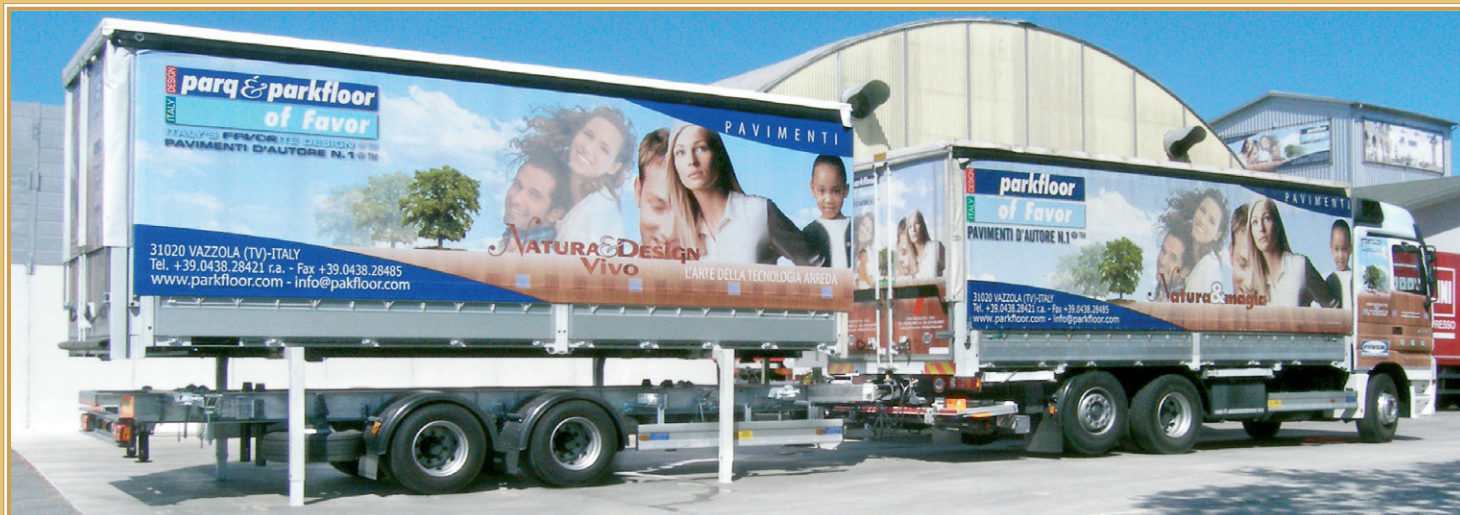
Biga 2 assi scarrabile con timone alto e piattaforma idraulica FAST Swap-body tandem-axle truck trailer with high drawbar and FAST hydraulic platform Plattform Zentralachsanhänger 2 Achsen Wechsellader mit hoher Deichsel und hydraulischer FAST
