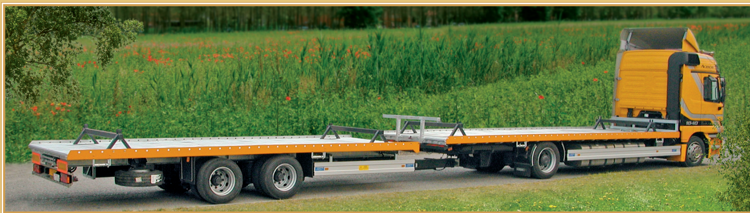
Convoglio portacaravan con timone allungabile per trasporti eccezionali Caravan transporter with extending drawbar for oversize loads Schleppzug Wohnwagenhänger mit verlängerbarer Deichsel für Spezialtransporte
