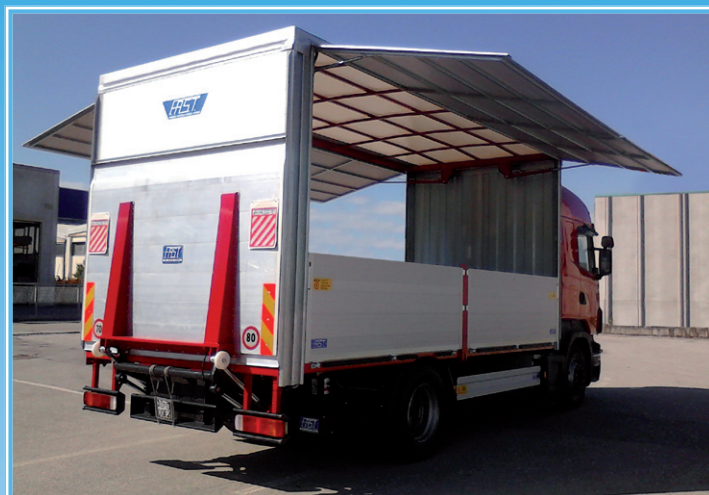
11- Sponda a battuta posteriore: particolare apertura idraulica pareti laterali cassone Rear liftgate: view of hydraulically opening body sides Ladebordwand: Detail hydraulisches Öffnen der Seitenwände des Aufbaus
