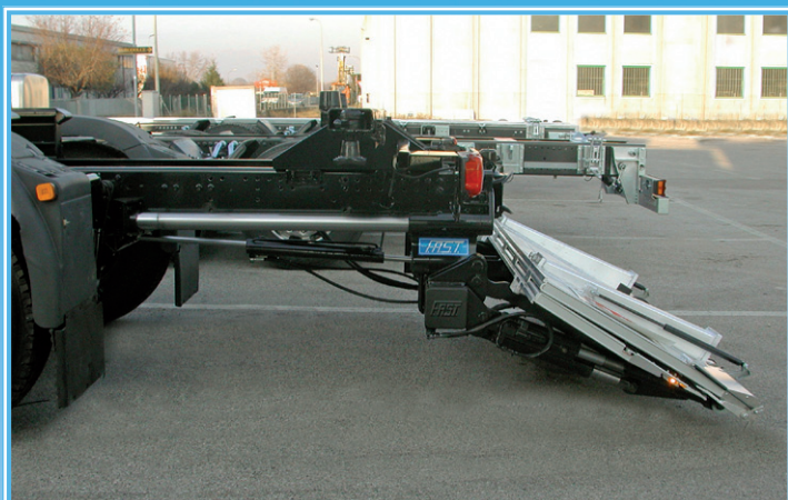
1- Pedana a doppia ripiegatura: particolare apertura Double folding platform: view of opening Doppelt faltbare Trittläche: Detail Öffnung
