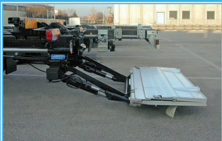
3- Pedana a doppia ripiegatura: particolare raccordo al suolo Double folding platform: view of contact with the ground Doppelt faltbare Trittläche: Detail Anschluss an den Boden
