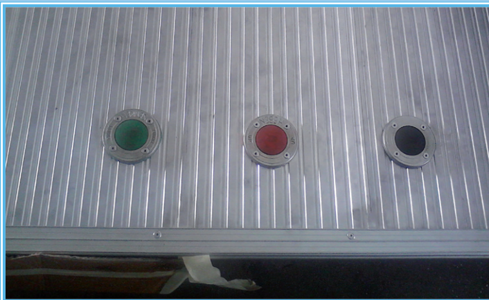
17- Pedana alluminio: particolare comandi a piede Aluminium platform: detail of foot controls Trittläche aus Aluminium: Detail der Fußsteuerung
