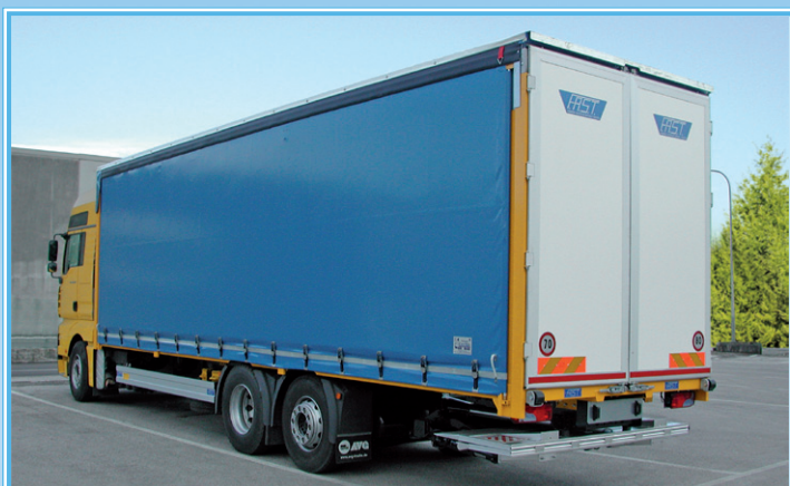
14- Sponda retrattile: posizione di marcia Retractable ramp: travelling position Einziehbare Hebebühne: Fahrposition
