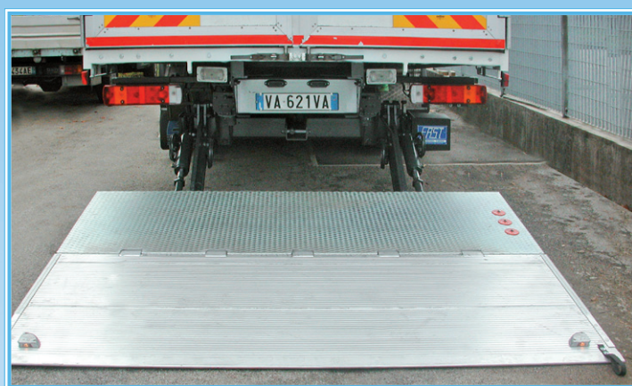
6- Pedana a semplice ripiegatura mista: punta in alluminio corpo zincato a caldo Mixed single folding platform: aluminium tip, hot-galvanised body Einfach faltbare Trittläche, gemischt: Spitze aus Aluminium und Korpus feuerverzinkt
