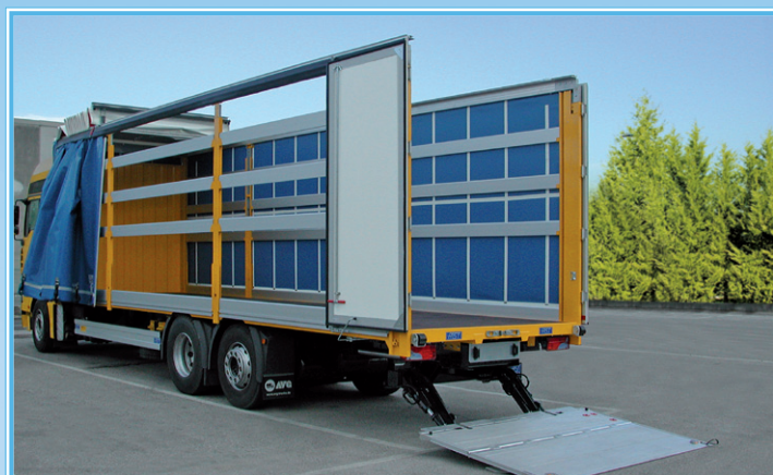
15- Sponda retrattile: posizione raccordo a terra con apertura vano carico su carrozzeria Retractable ramp: in contact with the ground with the cargo body open Einziehbare Hebebühne: Position am Boden mit Öffnung des Laderaums bei Aufbau
