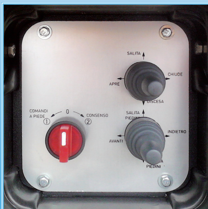
16- Consolle comando in ABS: particolare joy stick di comando ABS control panel: detail of the control joy-stick Steuerkonsole aus ABS: Detail des Joy Sticks zur Steuerung
