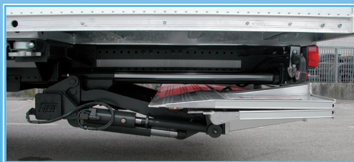
8- Pedana a semplice ripiegatura: posizione di marcia Single folding platform: travelling position Einfach faltbare Trittläche: Fahrposition
