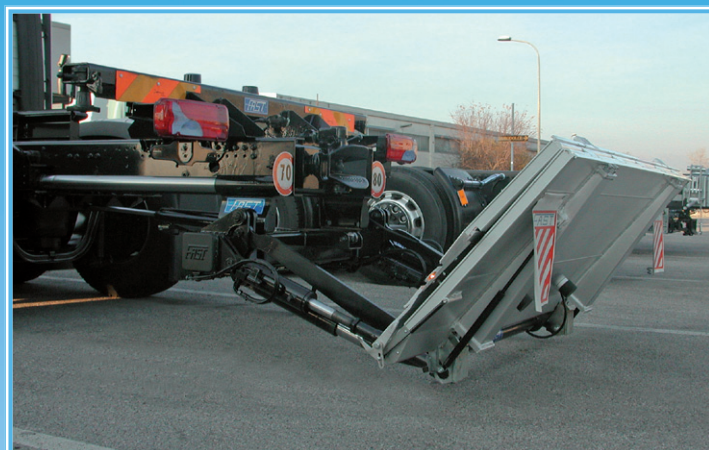
2- Pedana a doppia ripiegatura: particolare ribaltamento assistito con molle a gas Double folding platform: view of tilting assisted by gas struts Doppelt faltbare Trittläche: Detail mit Gasdruckfeder unterstützte Klappbewegungen
