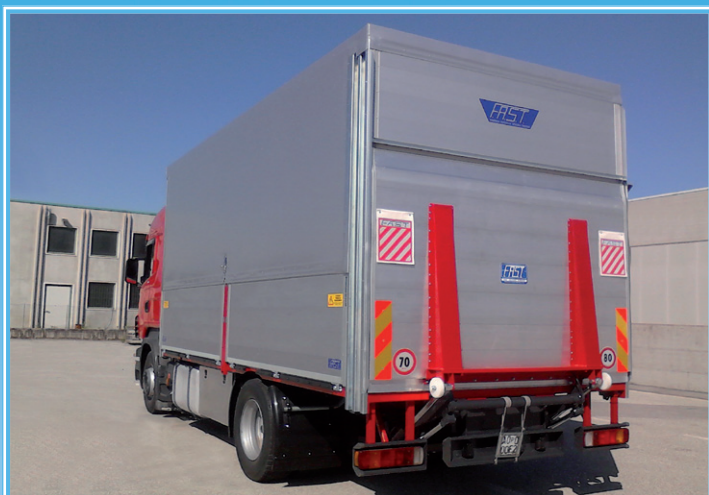
10- Sponda a battuta posteriore FW15CE in posizione di marcia FW15CE rear liftgate in the travelling position Ladebordwand FW15CE in Fahrposition
