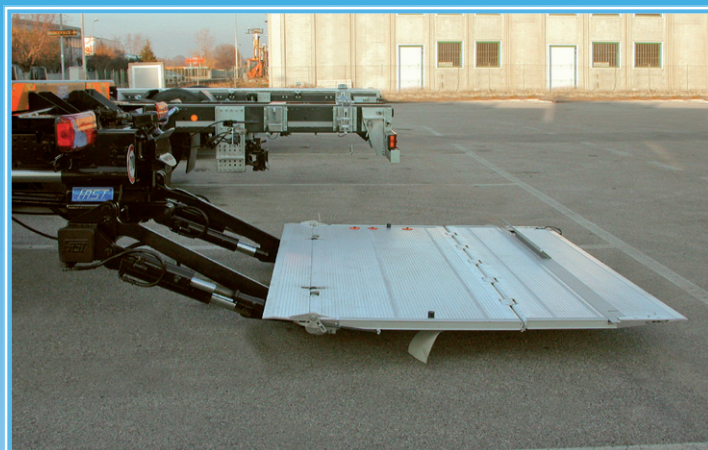
4- Pedana a doppia ripiegatura: particolare fermacarrelli a scatto Double folding platform: detail of trolley bumper Doppelt faltbare Trittläche: Detail Wagenstoppvorrichtung
