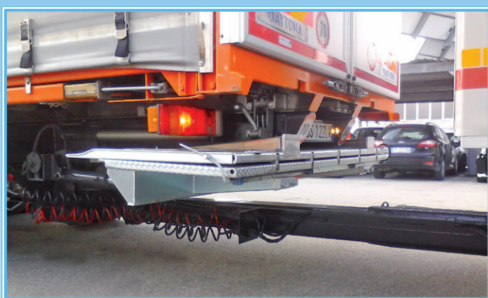
5- Sponda retrattile su veicolo con telaio rastremato per agganciamento timone biga Retractable ramp on the vehicle with frame fully withdrawn for attaching drawbar Einziehbare Hebebühne bei Fahrzeug mit sich verjüngendem Rahmen zum Einkuppeln der Deichsel eines Einachsenanhängers
