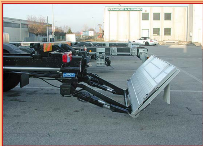
Timone con piedino di appoggio idraulico Drawbar with hydraulic stand Deichsel mit hydraulischem Stützfuß
