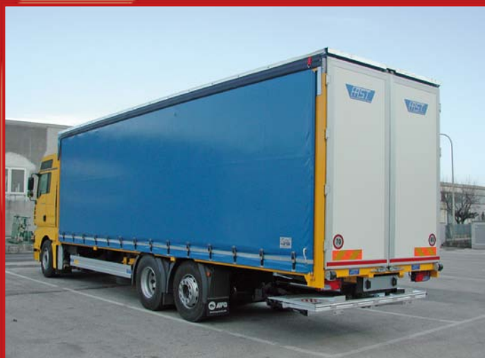
Timone con piedino di appoggio idraulico Drawbar with hydraulic stand Deichsel mit hydraulischem Stützfuß
