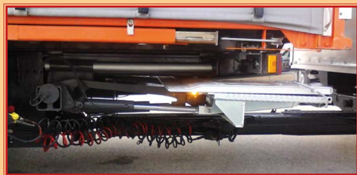
Timone con piedino di appoggio idraulico Drawbar with hydraulic stand Deichsel mit hydraulischem Stützfuß
